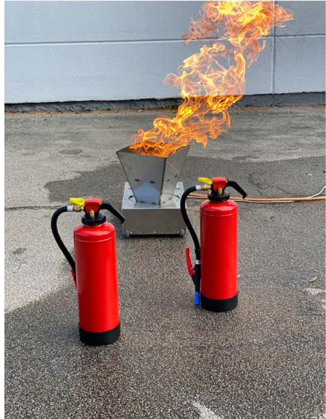
Abb. 6 Brandsimulator mit bereitgestellten Übungsfeuerlöschern
